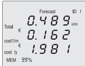
Durch Drücken der „MODE“-Taste für mind. 3s werden alle Anzeigen von „Consumption“, „History“, ON-time“ und „Forecast“ auf Null zurückgesetzt, sowie der Speicher „MEM“ gelöscht.
