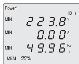
De maximale en minimale waarden slaat het meetapparaat automatisch op. Via de toetsen „max“ (4) of „min“ (3) worden deze waarden ca. 10 seconden lang in het display weergegeven. Opnieuw drukken van de toets schakelt voortijdig om naar de normale weergave.
