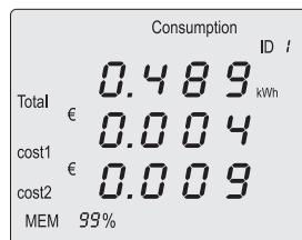
Druk één keer op de „max“-toets op de vooringestelde tariefwaarden voor tarief 1 en 2 af te lezen. Het display wordt na ca. 5 seconden automatisch teruggeschakeld.
