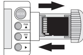
Zum Umschalten der Messwertanzeigen drücken Sie die Taste „MODE“ (5) oder die „Weiter“-Pfeiltaste (7). Jedes Drücken schaltet die Anzeige weiter.
