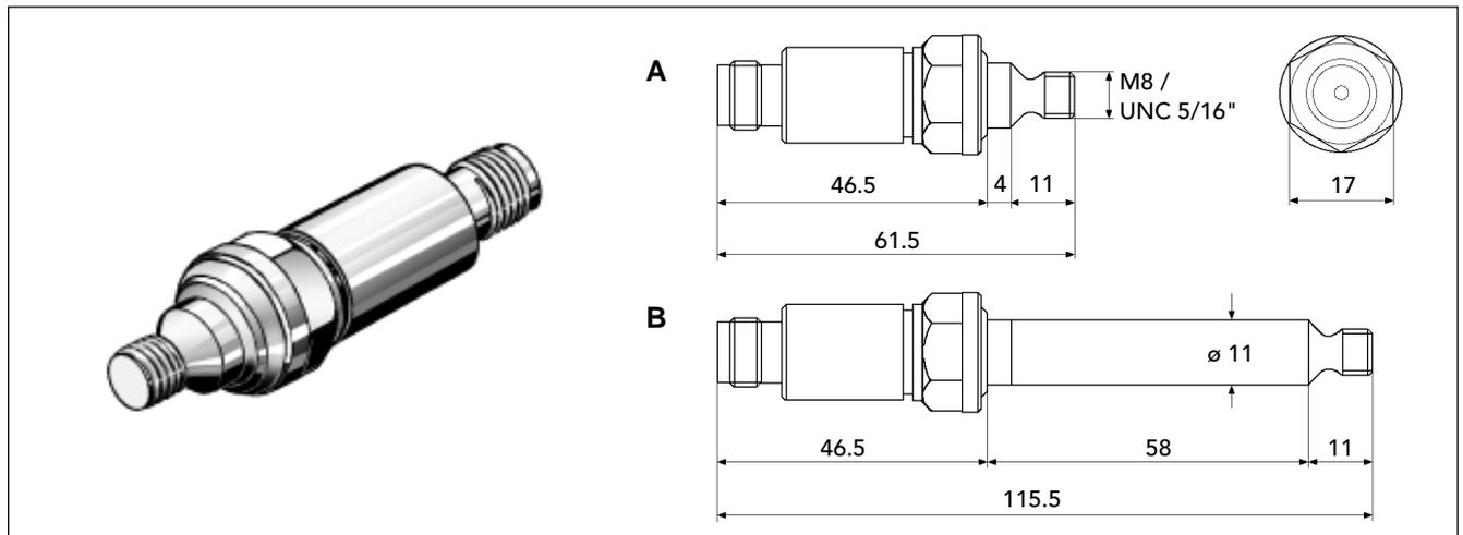
Standard-Stoßimpulsaufnehmer werden in allen SPM- Installationen für die Lagerüberwachung eingesetzt. Die Aufnehmer werden in angesenkte Montagebohrungen am Lagergehäuse eingeschraubt. Ein Stoßimpulsaufnehmer wandelt die vom Lager erzeugten Stoßimpulse in elektrische Signale um. Er wird über ein Koaxialkabel mit einem Meßterminal oder einem Meßgerät verbunden. Die maximale Kabellänge beträgt 4 m.
