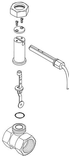
Durch die Kraft der Blattfeder, die gleichzeitig als Halterung für den Waagebalken dient, wird die Prallscheibe bei Ausbleiben der Strömung wieder in ihre Ruhelage gebracht.
