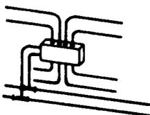
Configuration des lignes vers les points de graissage assurant un démontage facile.
