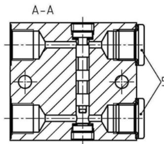
Vue des raccords principaux d'alimentation au choix à droite ou à gauche, les raccords non utilisés sont fermés avec des bouchons en G 3/8 (5)
