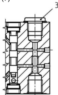
Sorties couplées avec bouchon de Fermeture (6) en G 1/4 et bague d'étanchéité (3) de la vis de fermeture G 1/4 avec une bague d'étanchéité (3)
