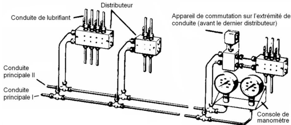
Connexion des distributeurs aux deux conduites principales à l'aide de tubulures d'alimentation (configuration en parallèle)
