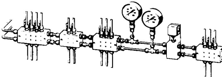
Selon la figure ci-dessus (branchement en série) des distributeurs de lubrifiant, le coût de l'installation en série est moindre que celui d'une configuration en parallèle. En raison de la chute de pression dans les distributeurs, cette configuration n'est à utiliser que dans les petits systèmes. Pour les grands systèmes, il est fortement recommandé d'utiliser des configurations combinées parallèle et série.
