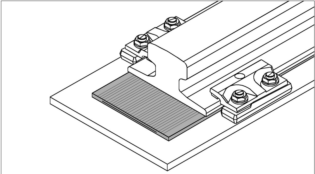
Die **GANTREX® MK6**-Unterlagen sind speziell zur elastischen Lagerung von Fahrschienen mit **GANTREX®**-Klemmen für kontinuierliche Befestigung auf Stahl oder auf Beton / Stahl entwickelt worden.
