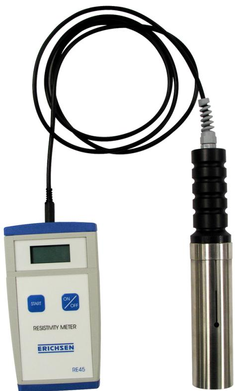
Abb. RESISTIVITY METER 515 mit Messsonde
