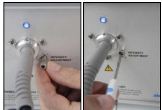
Regelung der Intensität mit Drehknopf (abnehmbar)
