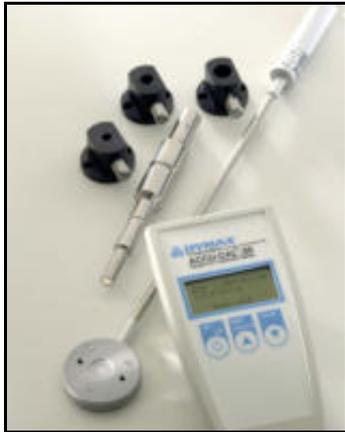
**Radiometer ACCU-CAL™ 50**
