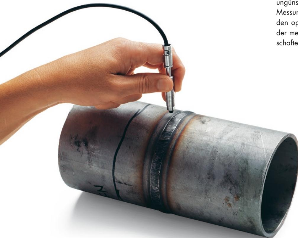
*Messung des Ferritgehaltes einer Schweißnaht*
