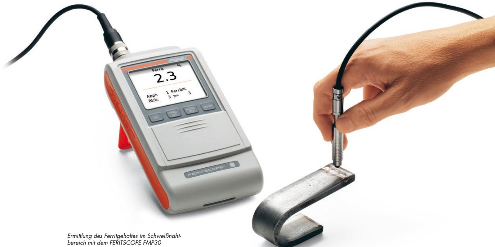
*Ermittlung des Ferritgehaltes im Schweißnahtbereich mit dem FERITSCOPE FMP30*
