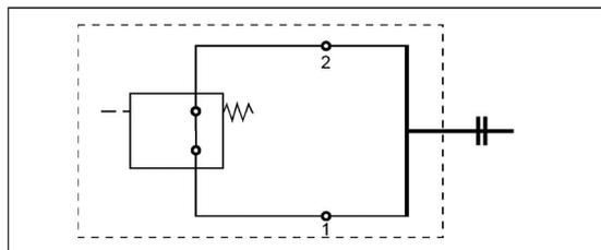
Die Wartungsanzeiger PiS 3084, 3087, 3093, 3098, 3193 dürfen bis zu 45 ° aus der Senkrechten eingebaut werden.
