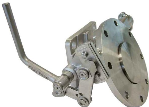
3" 30° донный клапан Cleanflow - во входном фланце просверлены 8 отв. x 14 мм, эквидистантные на диаметре 178 мм; в квадратном выходном фланце просверлены 4 отв. x 17 мм на диаметре 160 мм. Контактующие детали изготовлены из 316 нержавеющей стали с уплотнительным кольцом из фторита для основной тарелки в стандартной комплектации.
