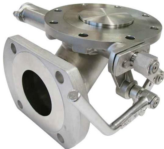
3" 90° донный клапан Cleanflow - во входном фланце просверлены 8 отв. x 14 мм, эквидистантные на диаметре 178 мм; в выходном фланце просверлены 4 отв. x 17 мм, эквидистантные на диаметре 160 мм с верхними и нижними фрезерованными плоскостями. Контактующие детали изготовлены из 316 нержавеющей стали с уплотнительным кольцом из фторита для основной тарелки в стандартной комплектации.
