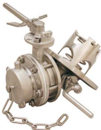
3" 45° составной узел нижнего слива - состоит из 3" 45° донного клапана, скрепленного болтами с 3" зажимным поворотным краном Widdop, заканчивающимся 3" BSP эксцентриковым выходным фланцем с крышкой из нержавеющей стали и прокладкой из фторопласта. Поворотный кран левостороннего управления. Контактующие детали изготовлены из 316 нержавеющей стали с основным уплотнением из фторопласта/ фортита.
