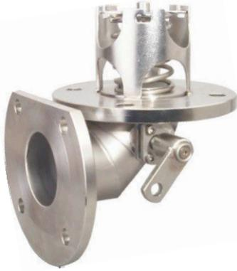
3" 90° донный клапан Highlift - во входном фланце просверлены 4 отв. X 18 мм на диам. 160мм; в выходном фланце просверлены 4 отв. x 17 мм на диаметре 160 мм с фрезерованной плоскостью на 72 мм к горизонтальной центральной линии. Контактующие детали изготовлены из 316 нержавеющей стали с уплотнительным кольцом из фортита для основной тарелки в стандартной комплектации.
