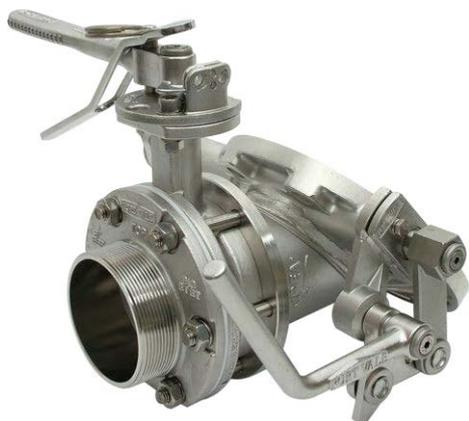
3" 45° составной узел нижнего слива - состоит из 3" донного клапана Cleanflow, скрепленного болтами с 3" зажимным поворотным краном, заканчивающимся 3" BSP выходным фланцем. Поворотный кран левостороннего управления. Контактующие детали изготовлены из 316 нержавеющей стали с основным уплотнением донного клапана из фортита и основным уплотнением поворотного крана из фторопласта.
