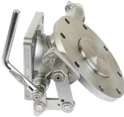
3" 45° донный клапан Cleanflow - во входном фланце просверлены 8 отв. x 14 мм, эквидистантные на диаметре 178 мм; наружный фланец просверлен как показано ниже. Контактующие детали изготовлены из 316 нержавеющей стали с уплотнительным кольцом из фортита для основной тарелки в стандартной комплектации.
