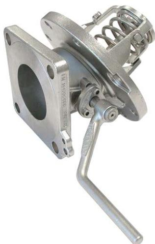
3" 30° донный клапан MKIII Highlift - во входном фланце просверлены 8 отв. X 14 мм, эквидистантные на диаметре 178 мм; в выходном фланце просверлены 4 отв. x 17 мм, эквидистантные на диаметре 160 мм. Контактующие детали изготовлены из 316 нержавеющей стали с уплотнительным кольцом из фортита для основной тарелки в стандартной комплектации.
