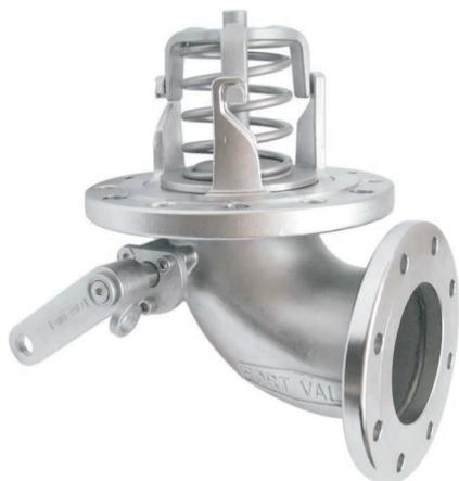
3" 90° донный клапан Tankstream - 3" для 3" 90° узла донного клапана. Во внутреннем фланце просверлены 12 отв. х 14 мм на диаметре 6,25". 6 отв. на впуске закрыты пластиковыми пробками. В выходном фланце просверлены 8 отв. х 10,5 мм на диаметре 124 мм. Контактующие детали изготовлены из 316 нержавеющей стали с основным уплотнением из фторита или витона.
