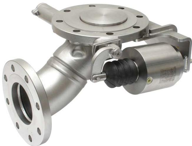
4" 90° пневматический донный клапан Cleanflow - во входном фланце просверлены 8 отв. x 18 мм, эквидистантные на диаметре 210 мм (DIN125 PN16); в выходном фланце просверлены 8 отв. x 18 мм, эквидистантные на диаметре 180 мм (DIN100 PN16). Контактующие детали изготовлены из 316 нержавеющей стали с уплотнительным кольцом из фортита для основной тарелки в стандартной комплектации.
