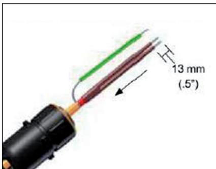
**3b.** Натяните соединительную гильзу на конец кабеля с клеем и желто-зеленый кожух для заземления на скрученную оплетку. Зачистите 13 мм (0,5 дюйма) жилы кабеля.
