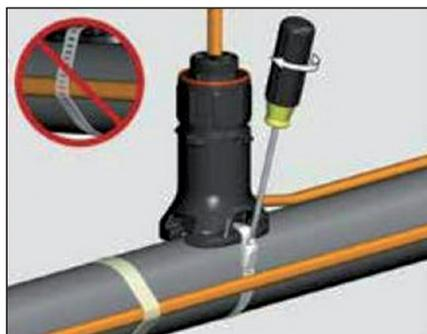
**Terminator:** Протяните кабель через отверстие в основании колонки и закрепите монтажную колонку на трубе при помощи бандажной ленты. Не устанавливайте бандажную ленту поверх кабеля.
