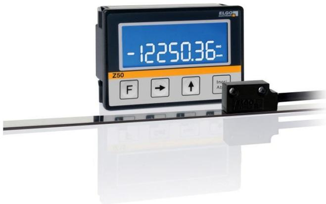
Die kompakte Z50-Positionsanzeige verfügt über eine 14 mm hohe LCD-Anzeige und ermöglicht dadurch ein bequemes und präzises Ablesen der Ist-Position. Die Anzeige kann wahlweise über das staubdichte Fronttastenfeld oder über externe Signale auf 0 oder auf einen beliebigen Referenzwert gesetzt werden. Der Zähler verarbeitet inkrementelle Rechtecksignale, z. B. von konventionellen Drehimpulsgebern oder den magnetischen ELGO-Inkremental-Messsystemen LMIX, EMIX, MIX, PMIX.
