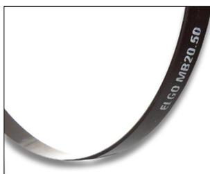
**Lagerungshinweis, bitte beachten:** Um Spannungen im Magnetband zu vermeiden, sollte es gestreckt oder aufgerollt - mit dem magnetisierten Kunststoffband bzw. der Abtastseite nach außen - gelagert werden.
