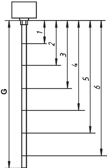
Bitte beachten Sie bei der Planung, dass die Schwimmschalter **beim Aufschwimmen nicht in der Waagerechten** schalten, sondern so, wie in den Prinzipbildern der einzelnen Schwimmschalter auf den Seiten 1-1-6 ff. dargestellt.
