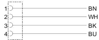
Kontaktbelegung freies Leitungsende
