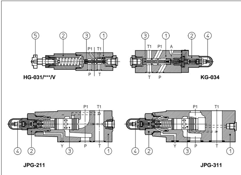
Le valvole HG, KG, JPG sono valvole modulari di riduzione pressione a cursore ③ progettate per funzionare in sistemi oleoidraulici.
