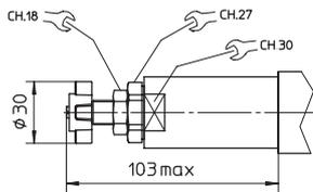
Dispositivo di regolazione per opzione /VS
