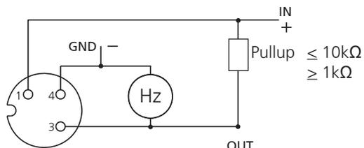
Frequenz Ausgang gefiltert Impuls Ausgang
