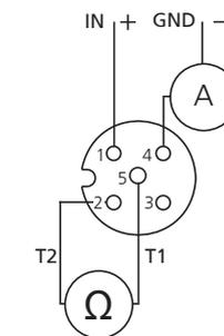
Strom Ausgang mit Temperaturmessung PT1000
