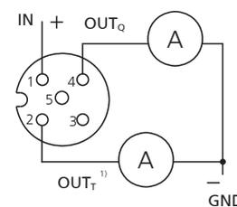
Strom Ausgang mit Temperaturmessung 4 ... 20 mA
