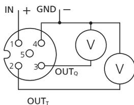
Spannung Ausgang mit Temperaturmessung 0 ... 10 V
